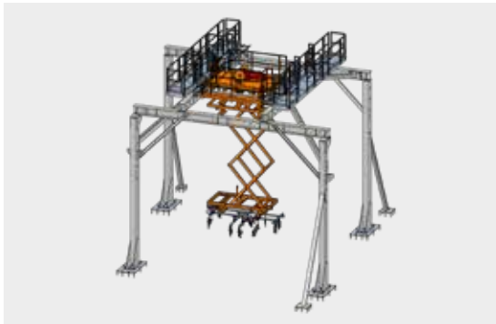
Portal mit Hubtisch
